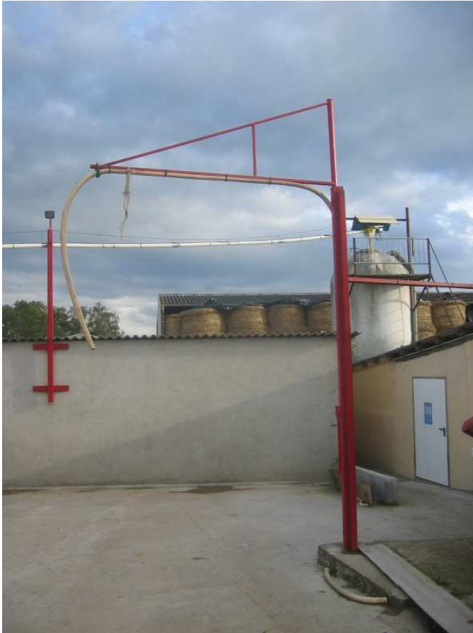
Potence réalisée en matériaux de récupération
